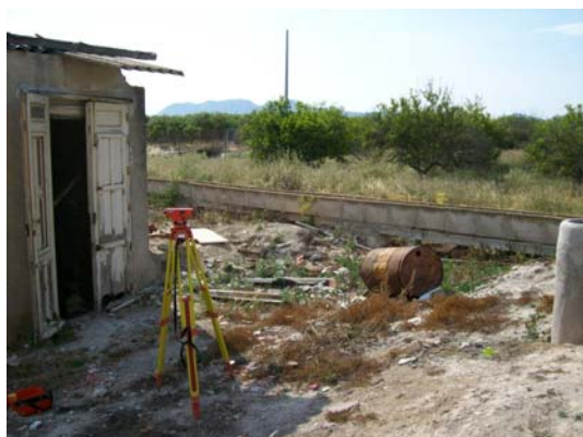
Nivel automático Sokkia E32 utilizado para la nivelación geométrica
