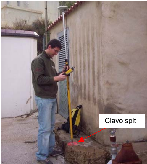
Toma de las coordenadas y cota en el punto de referencia situado en el pozo 293250055
